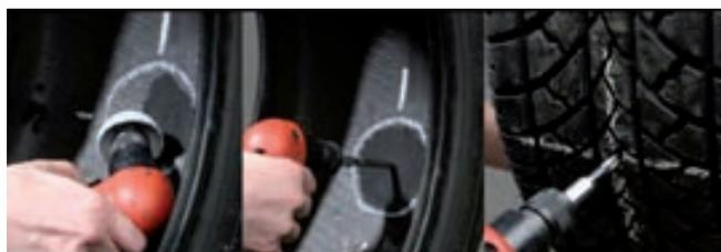
Levigare l'area delimitata utilizzando una mola per rasatura pulita e affilata su una smerigliatrice a bassa velocità (max 5.000 giri al min.). Rimuovere tutte le nervature e le disparità del tessuto fino a renderlo morbido e vellutato. (Vedi Bollettino Nr. 29 dell'Associazione Produttori Gomma "Standard Buffing Texture – Retreading and Repairing" - RMA #1 o RMA #2).
