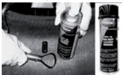
Rimuovere contaminanti e silicone dall'innerliner del pneumatico prima della marcatura/raspatura con il detergente PREMA Pre Buff PPC.
