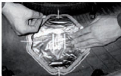
Centrare il rappezzo sul danno in modo che le linee sul liner e quelle sul rappezzo coincidano. Segnare i confini attorno al rappezzo con un gessetto.
