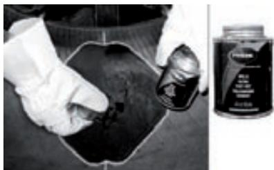
Applicare uno strato uniforme di mastice PREMA ad essiccazione ultrarapida Ultra Fast Dry sulla superficie smerigliata. Lasciare asciugare del tutto e NON usare mezzi artificiali di essiccazione.
