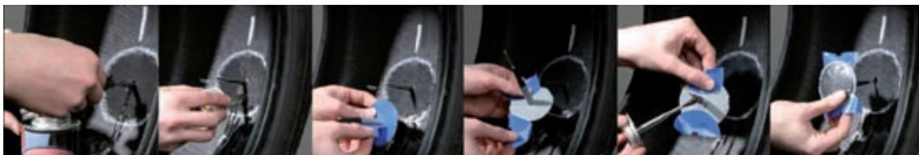
Con l'utensile d'inserimento a spirale applicare uno strato di mastice di vulcanizzazione PREMA Ultra Fast Dry nel canale del danno, lavorando dall'interno del pneumatico. Ripetere l'operazione due o tre volte in modo da rivestire per bene il canale.
