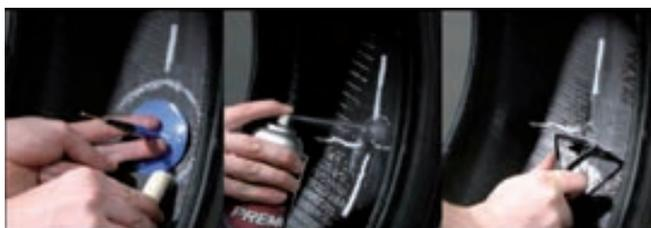
Centrare l'unità di riparazione sul danno all'interno del pneumatico e tracciare una linea attorno al bordo esterno dell'unità di riparazione.
