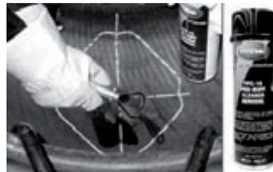
Rimuovere contaminanti e silicone dall'innerliner del pneumatico prima della marcatura/raspatura con il detergente PREMA Pre Buff PPC.
